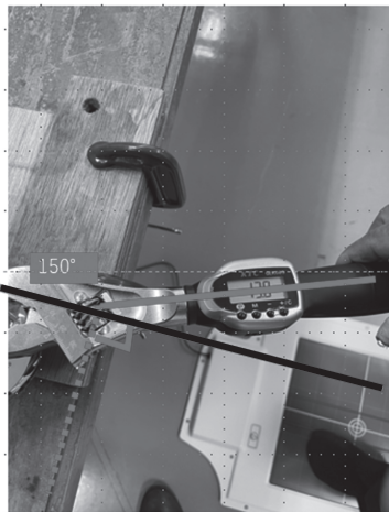
図6 デジタルラチェットレンチを立位時の体幹の正面に対し150°の位置に固定設置
